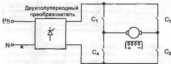
Рис. 9.12в. Регенеративное торможение
