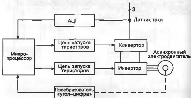
Рис. 9.23. Блок-схема привода с обратной связью, управляемого микропроцессором, для регулирования скорости вращения асинхронного электродвигателя
