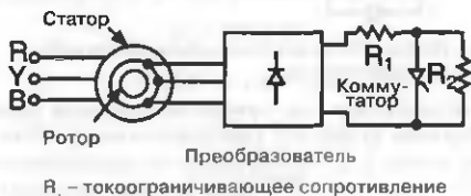
Рис. 9.6а. Динамическое торможение дополнительным сопротивлением в цепи ротора
