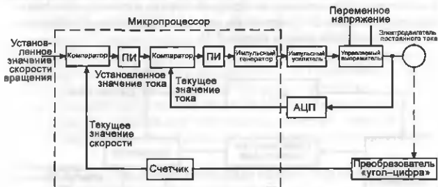
Рис. 9.22г. Блок-схема привода с обратной связью, управляемого микропроцессором
