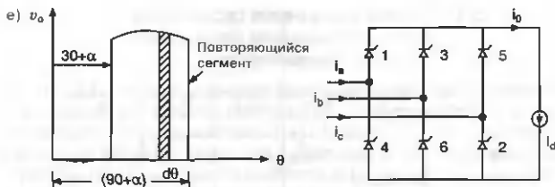
Рис. 4.11. а) Одиночный сегмент выходного напряжения
