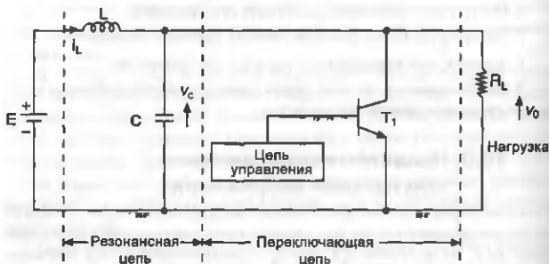
Рис. 10.1. Резонансный преобразователь со связью по постоянному току
